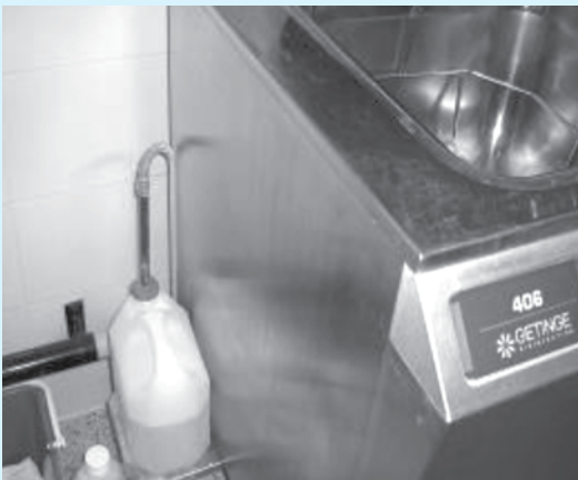
Mejora en la tapa del desinfectante para evitar derrames. (Hospitalización).
