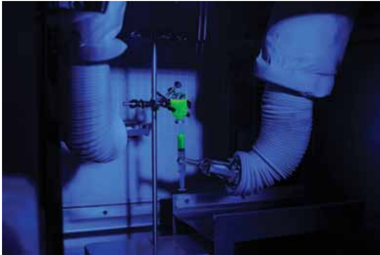
Brazo robótico, para manipulación del radiofármaco.
